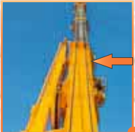
Gleitführungen in einem Kranausleger
