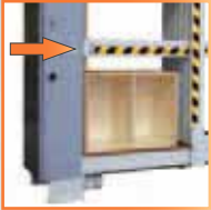
Trapezgewindemutter in einer Möbelkorpuspresse
