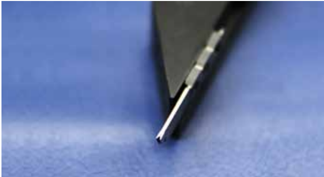
Werkzeug zum Abstechen dünnwandiger Teile
