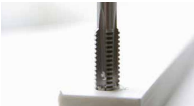
Gewindeherstellung mit Gewindebohrer
