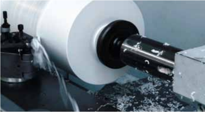
Fließspan beim Drehen
